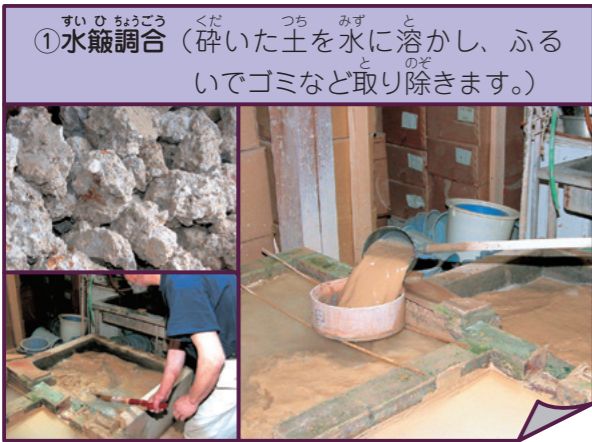
①水簸調合（砕いた土を水に溶かし、ふるいでゴミなど取り除きます。）
