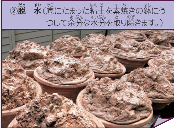
②脱 水（底にたまった粘土を素焼きの鉢につして余分な水分を取り除きます。）
