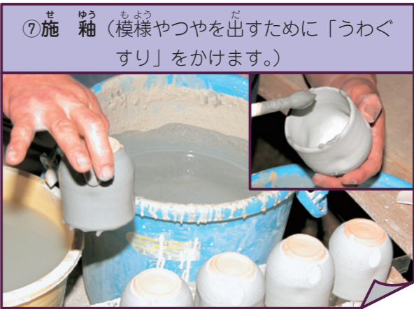
⑦施 釉（模様やつやを出すために「うわぐすり」をかけます。）
