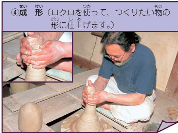
④成 形（ロクロを使って、つくりたい物の形に仕上げます。）
