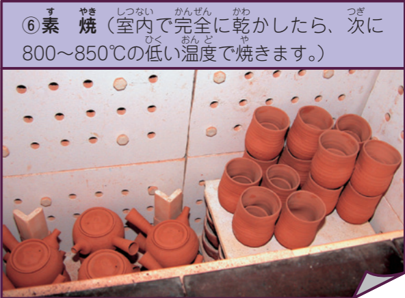
⑥素 焼（室内で完全に乾かしたら、次に800～850℃の低い温度で焼きます。）
